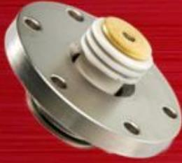
**Brasage** : Les brasures utilisées dépendront des divers paramètres, température d'utilisation, nature du métal à assembler, nécessité de brasier plusieurs métaux de nature différente, les alliages de brasure type Ag/Cu, Ag/Cu/pd, Au/Ni, Au/Cu, Ag, Au, Cu, sont courants et permettent de couvrir une plage de **780°C à 1080°C**.
