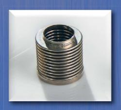
Cette technique consiste à effectuer un dépôt métallique (nickel, cuivre, or...) sur un support, sur lequel a été préalablement reproduit par voie photographique, la pièce à réaliser ou en 3 D sur un mandrin usiné.
